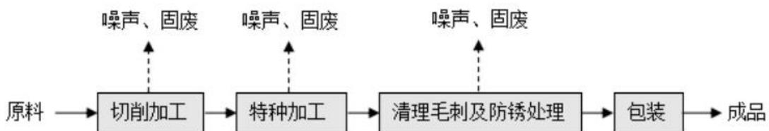
图3 机加工产品生产工艺流程图
